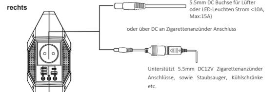
Unterstützt 5.5mm DC12V Zigarettenanzünder Anschlüsse, sowie Staubsauger, Kühlschränke etc.
